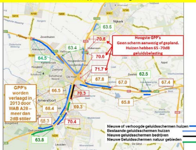
Huidige + gepland "wettelijke doelmatige" schermen en Gemiddelde GPP (2008) in Planstudie Knooppunt Hoevelaken gebied
